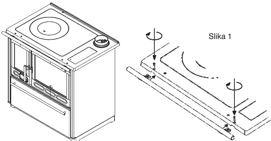
Dimni nastavek priključite na predvideno mesto na štedilniku. Potrebno je upoštevati to, da je spoj štedilnika in dimnika narejen trdno in nepropustno. Štedilnik se priključuje na dimnik s standardno cevjo premera Ø120 mm. Dimovodne cevi morajo imeti na vseh mestih ustreznii vzpon. Ne povezujte štedilnika z dimnikom, na kateri je že priključen kakšen drugi porabnik. Potrebno je pregledati dimnik, da ne bi bilo poškodb in razpok.
