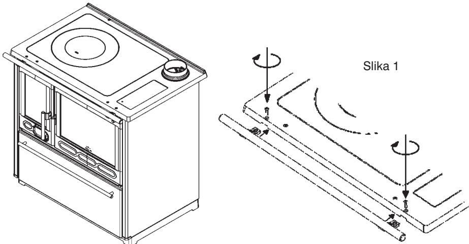
Na odgovarajuće mjesto postavite dimni nastavak. Potrebno je voditi računa da spoj štednjaka i dimnjaka bude izведен čvrsto i nepropusno. Štednjak se priključuje na dimnjak standardnom cijevi promjera Ø120 mm. Dimovodne cijevi moraju imati na svim mjestima odgovarajući uspon. Ne povezujte štednjak s dimnjakom na kojem je već priključeno neko drugo trošilo. Potrebno je pregledati dimnjak, da nema oštećenja i pukotina.
