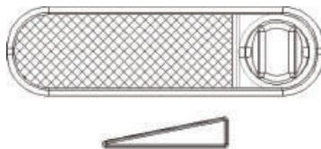
Wenn das Feuer entfacht und genügend Glut entstanden ist, stellen wir den Schieber auf die Position, die benötigt wird, damit der Ofen die benötigte Wärme entwickelt.
