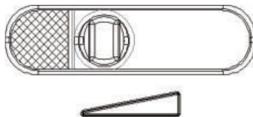
Pro minimální výkon regulátor primárního vzduchu úplně uzavřete, a pokud máte v kouřovodě zabudovanou záklopku, přivřete jí.
